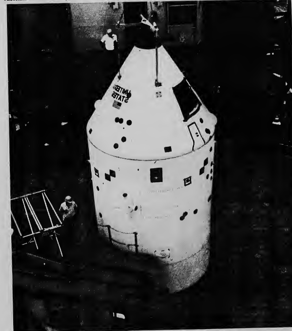
INSPECCION DI APOLLO-E Capsula di comando Apolo ta ser di check door di ingeniero na Cape Kennedy, Florida prome cu nan pegue na e vehiculo Saturno SA-7 cu nan ta bay lanza.
